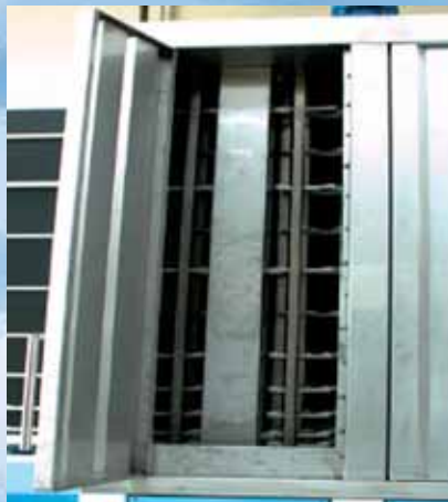
MODULO PRELAVAGGIO / PRE-WASHING SECTION
