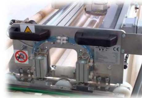
( cambio de paso de rodillos para gestionar diferente pasos y diferente diámetro rodillos
