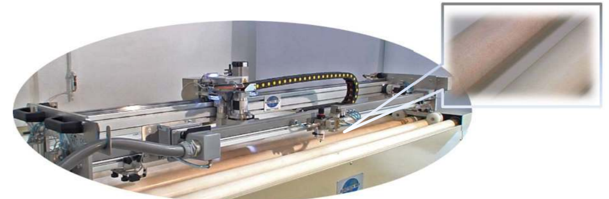
(dispositivo de cambio de paso de rodillos para gestionar diferente pasos y diferente diámetro rodillos)
