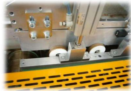
( CRR en fase de adelantamiento sobre los rodillos )
